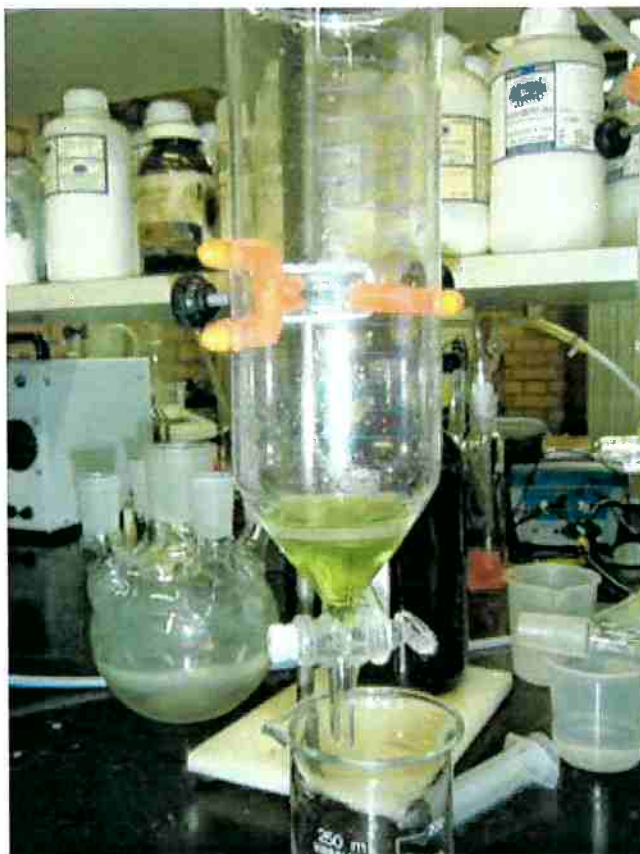
Figura 18 – Separação das soluções imiscíveis em funil de separação.
