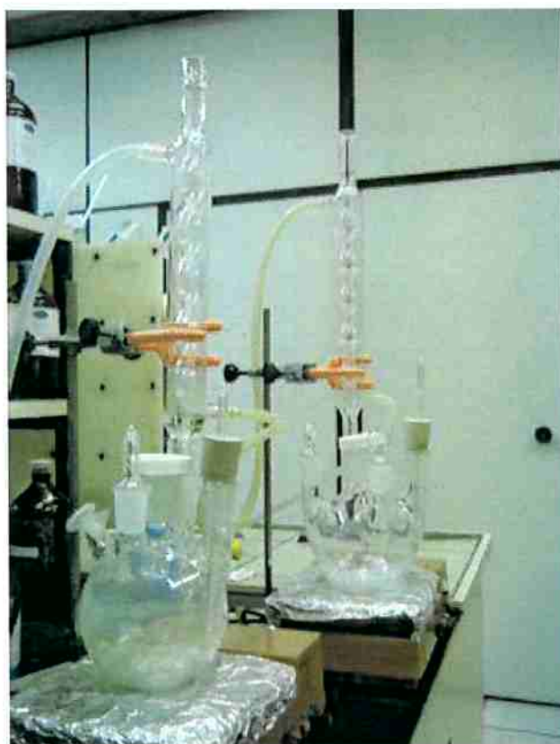
Figura 16 – Sistema de aquecimento e refrigeração utilizado na etapa de mistura de Oxalato de Amônio à solução estudada.
