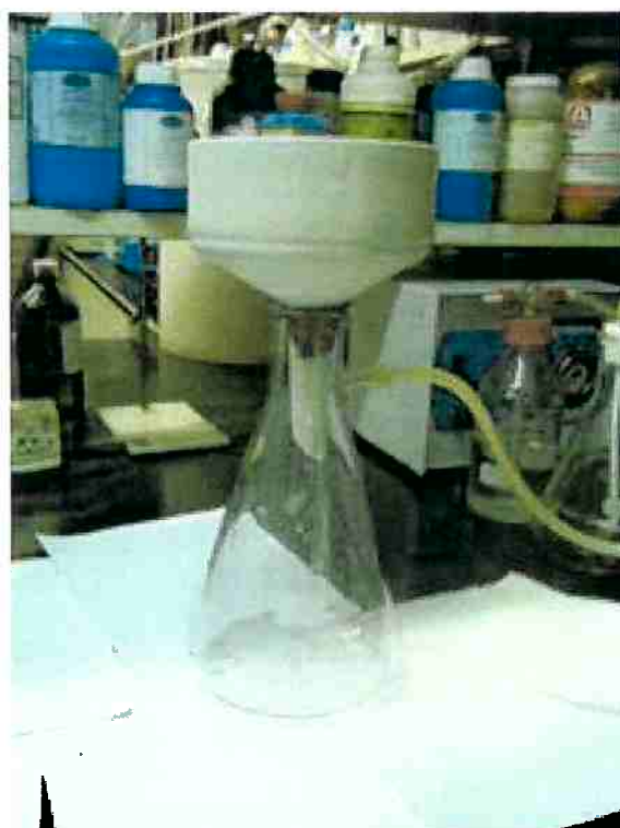
Figura 14 - Esquema de ligação do filtro a vácuo.
