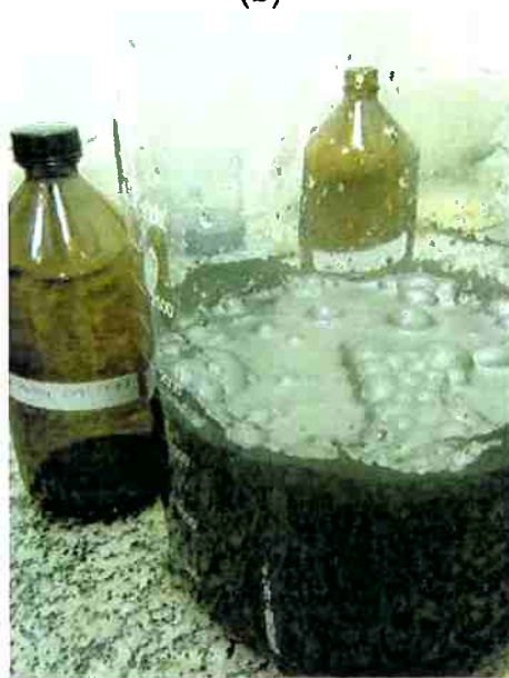
Figura 13 – Sequência da etapa de lixiviação. (a) Mistura do pó com ácido sulfúrico. (b) Idem. (c) Reação de lixiviação em andamento.
